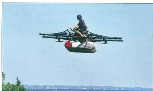
KittyHawk Flyer. Cet ULM sur flotteurs à moteur électrique, première réalisation de la pépinière d'entreprises lancée par Larry Page, le fondateur de Google, pour promouvoir l'avion électrique, s'est livré à quelques démonstrations sur le lac Winnebago.
